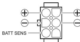
Cette prise permet également de commander la puissance de sortie. Si vous mettez la broche 3 (BATT SENS) de la prise alimentation DC à la masse, le **FT-857D** passe automatiquement à 20 Watts (10 Watts sur 430 MHz) de puissance de sortie.
