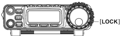
Dans la configuration par défaut de l'émetteur récepteur, l'appui sur le bouton **LOCK** désactive juste le **DIAL**, tandis que les autres touches et commutateurs ne sont pas affectés.
