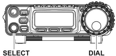
Le pas d’incrément du synthétiseur pour le bouton **SELECT** peut être ajusté indépendamment par mode. Utiliser le menu n° 006 [AM STEP] pour l’AM, n° 052 [FM STEP] pour la FM,
